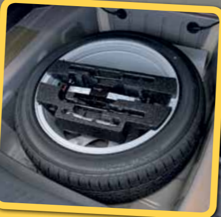
▲ ... и при этом под полом помещается полноразмерная запаска на литом диске R17!
