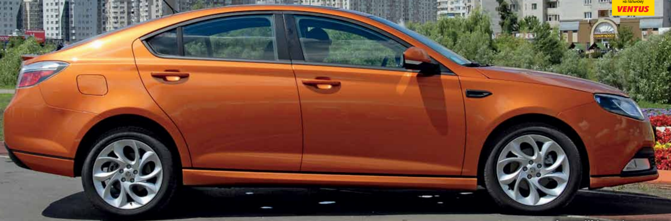
С завода MG 6 идет обутом в резину Goodyear размерности 215/50 R17
