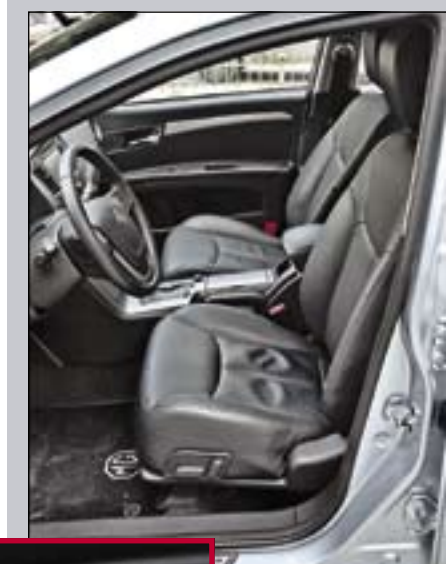
Сиденья – со слабой боковой поддержкой, но мягкие и комфортабельные. Однако обивка на водительской подушке уже потянулась пузырями. Наши кресла оборудованы электроприводами и механическим рычагом изменения поясничного подпора.
