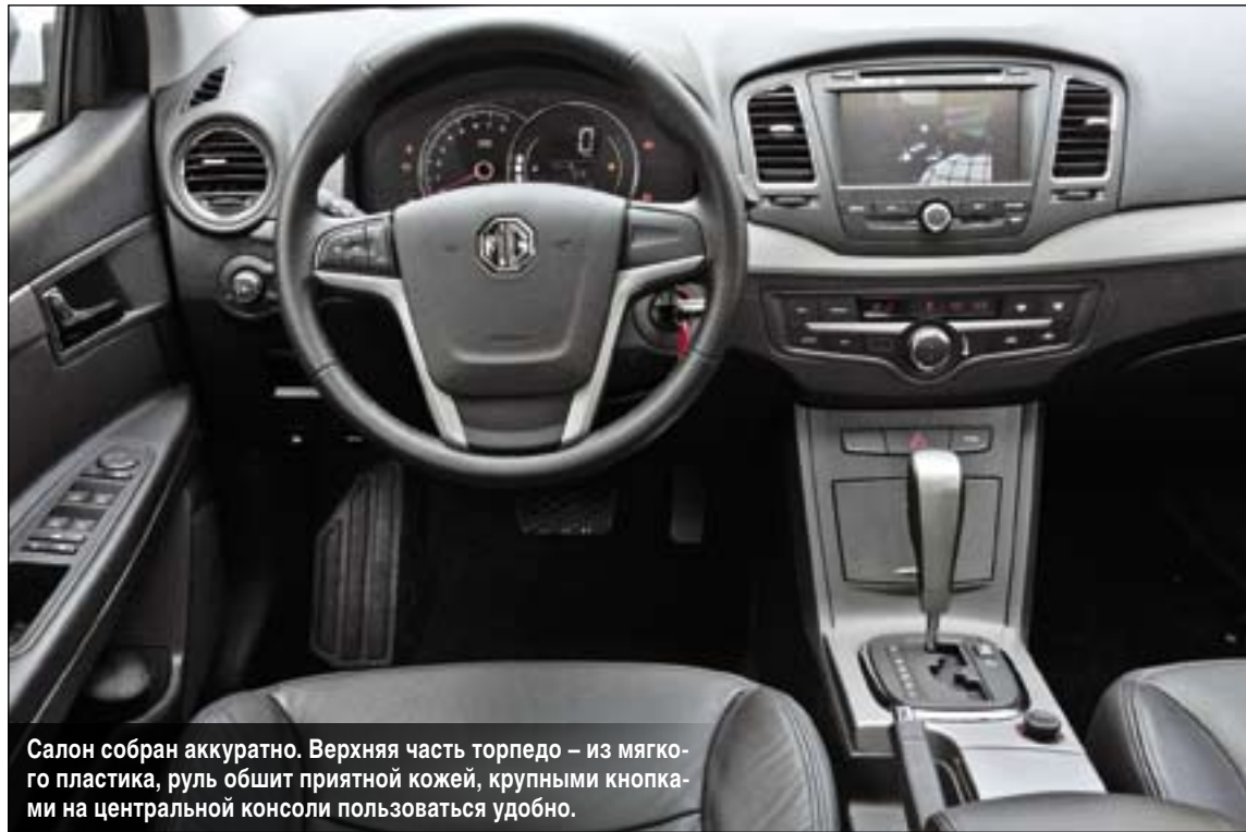
Сиденья – со слабой боковой поддержкой, но мягкие и комфортабельные. Однако обивка на водительской подушке уже потянулась пузырями. Наши кресла оборудованы электроприводами и механическим рычагом изменения поясничного подпора.
