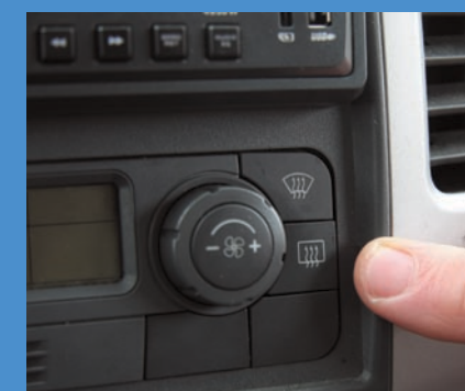
Эти кнопки «заводят» интенсивным обдувом теплым воздухом ветрового стекла (1) и электрообогревом зеркал (2).
