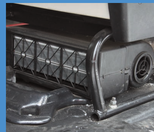
Обогреватель салона, расположенный под передним сиденьем, отличается высокой эффективностью.
