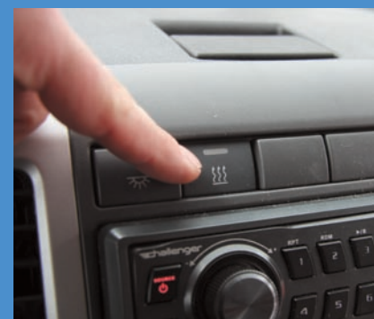
Нажатием специальной кнопки на передней панели включается обогреватель охлаждающей жидкости.
