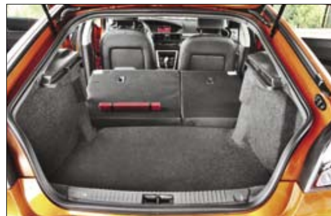
Лифтбек предлагает более легкую погрузку вещей, чем седан, так как крышка багажника поднимается вместе со стеклом. И хотя в походном состоянии объем отсека на 23 л меньше, чем у MG 550, но при сложенном заднем ряде он на 563 л больше.
