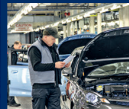
Помимо контроля в процессе сборки, каждая машина проверяется на участке контроля качества в конце нитки конвейера.
