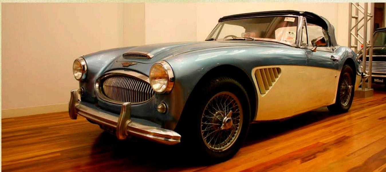
➌ Одна из прославленных и вместе с тем последних моделей классической спортивной школы – Austin-Healey 3000 Mark III. Автомобиль был представлен в конце 1963 года. Под капотом – 2,9-литровый двигатель с двумя карбюраторами, развивавший 148 л.с. Примечательно, что из 17 712 выпущенных машин львиная доля в 15 407 авто ушла на экспорт в США.
